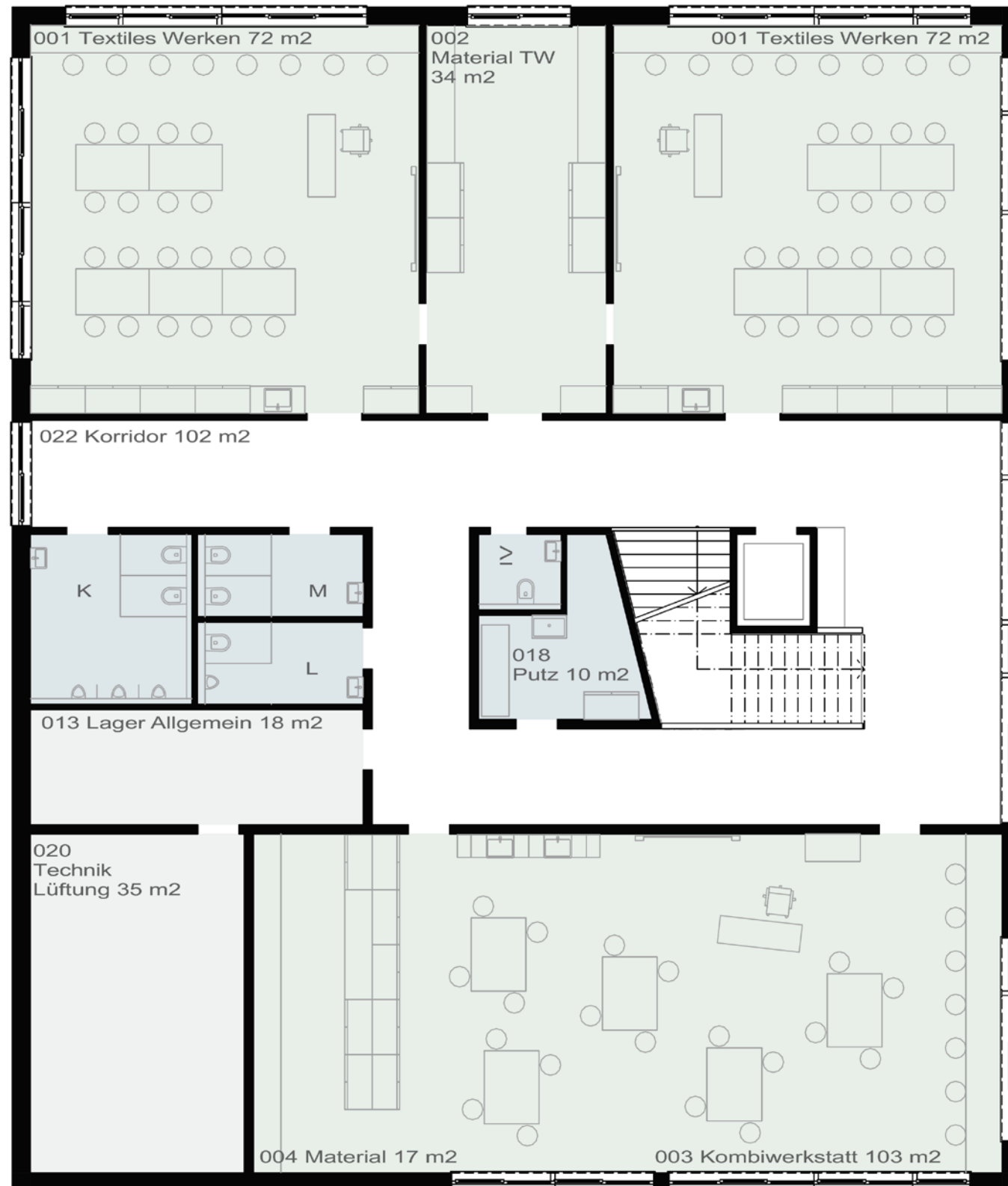
Grundriss 1. Obergeschoss Erweiterungsbau
